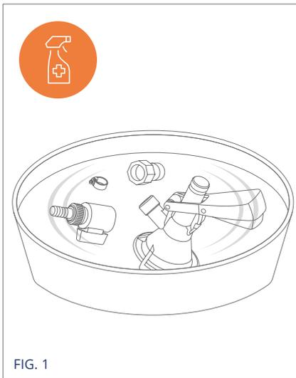
Desmontar el kit para el llenado PolyKeg® y esterilizar las partes como indicado en la sección "Instrucciones para la esterilización".
